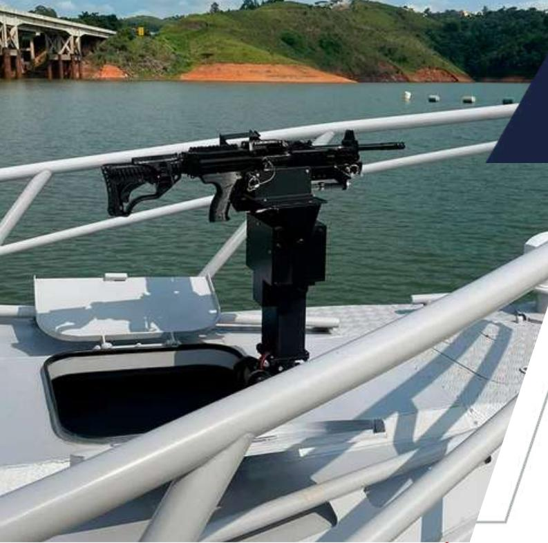
O Guapará foi desenvolvido para embarcações militares, sendo estabilizado nos eixos de azimute e de elevação para manter a estabilidade da linha de tiro, ou seja, uma vez apontado, trava no alvo até atingir o seu limite mecânico.
